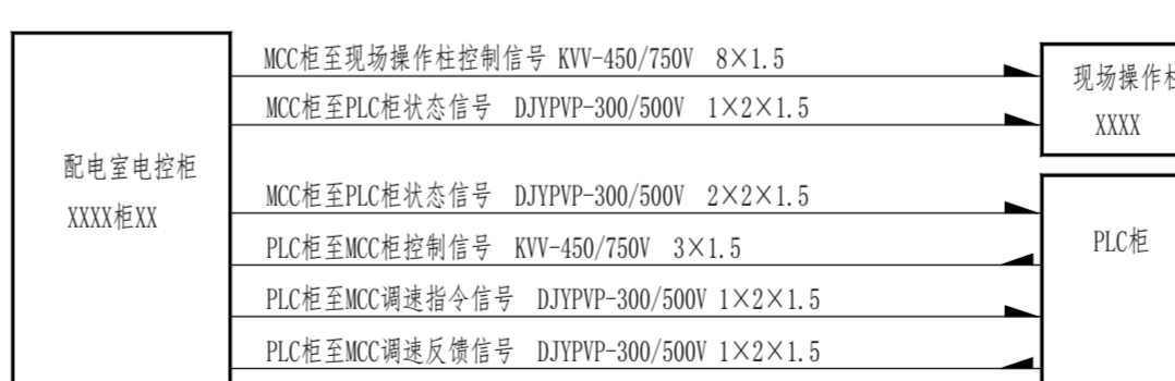
电气线缆连接示意图
